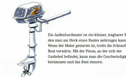
Ein Außenbordmotor ist ein kleiner, tragbarer Motor, den man am Heck eines Bootes anbringen kann. Wenn der Motor gestartet ist, treibt die Schraube das Boot vorwärts. Mit der Pinne, an der sich der Gashebel befindet, kann man die Geschwindigkeit bestimmen und das Boot steuern.
