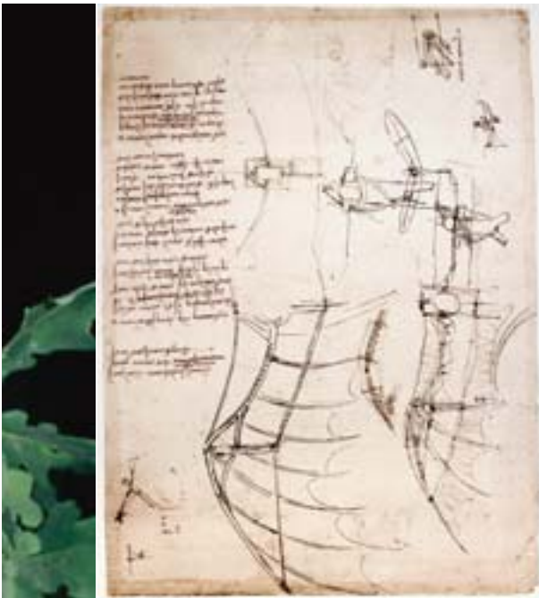
Bei diesem Fluggerät sind die langen dünnen Fingerknochen der Fledermaus als Holzstreben in den Flügeln eingepflanzt.
